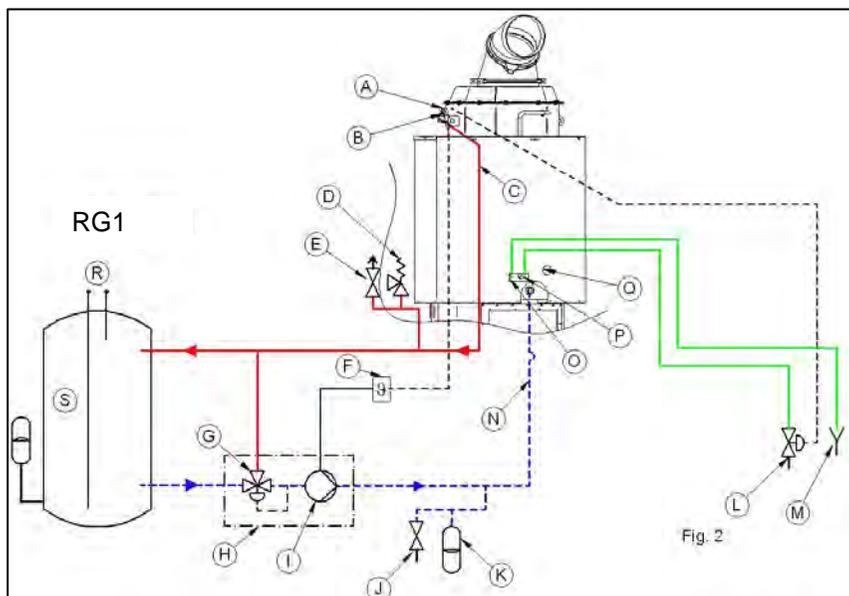
Variante d'intégration possible du RG1 à une installation de chauffage
