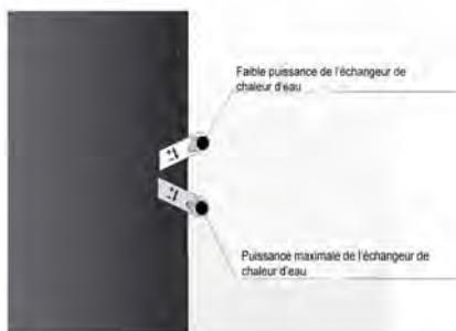
du levier se trouvant du côté droit de la face arrière (voir Fig. 10). On passe ainsi de l'allumage à la combustion. Des positions intermédiaires du levier ne sont pas prévues.
