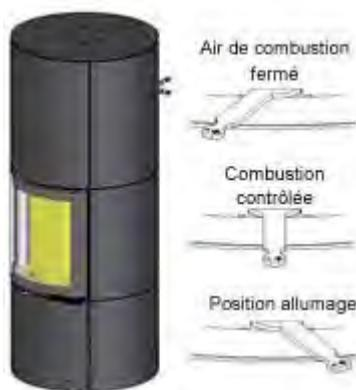
La régulation de l'air de combustion s'effectue en continu, par actionnement du levier de réglage qui se trouve sous la porte (voir Fig. 8). Le réglage s'effectue à porte de foyer fermée !
