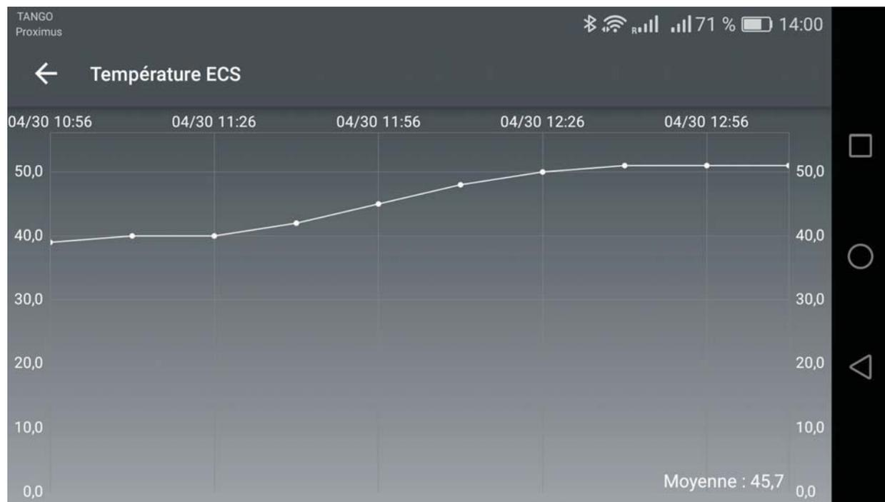
Charge ECS: t° désirée 45°, hystérésis: 2°, surchauffe chaudière 7° = 52°.
