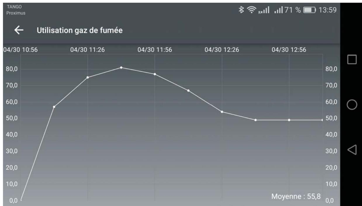
La chaudière module sa puissance = modulation utilisation extracteur fumées.
