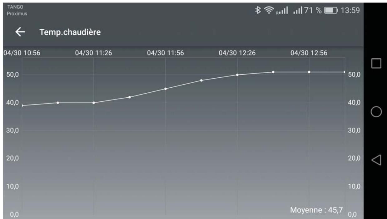
La Biostar fonctionne et module à basse t°.
