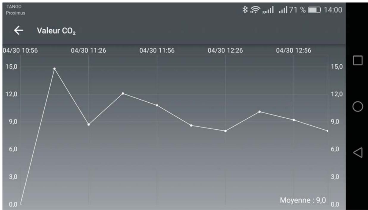
Target CO<sub>2</sub>: 12% à plein régime et inférieur en modulation.
