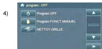
Mode chauffage et préparation ECS coupés → fonction hors gel active
