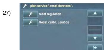
Chargement de la configuration d'usine → L'installation doit être reconfigurée !!!
