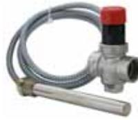
La soupape de sécurité thermique ESBE de la série VST100 est conçue pour empêcher les excès de température dans les chaudières à combustibles solides dans les systèmes de chauffage hydrauliques à circuit fermé. Raccords d'entrée à filetage intérieur, DN20.
