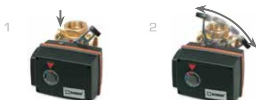
1 Pour passer en mode manuel, appuyez sur le bouton et utilisez le levier. Le courant électrique est automatiquement coupé tant que le bouton reste enfoncé.
